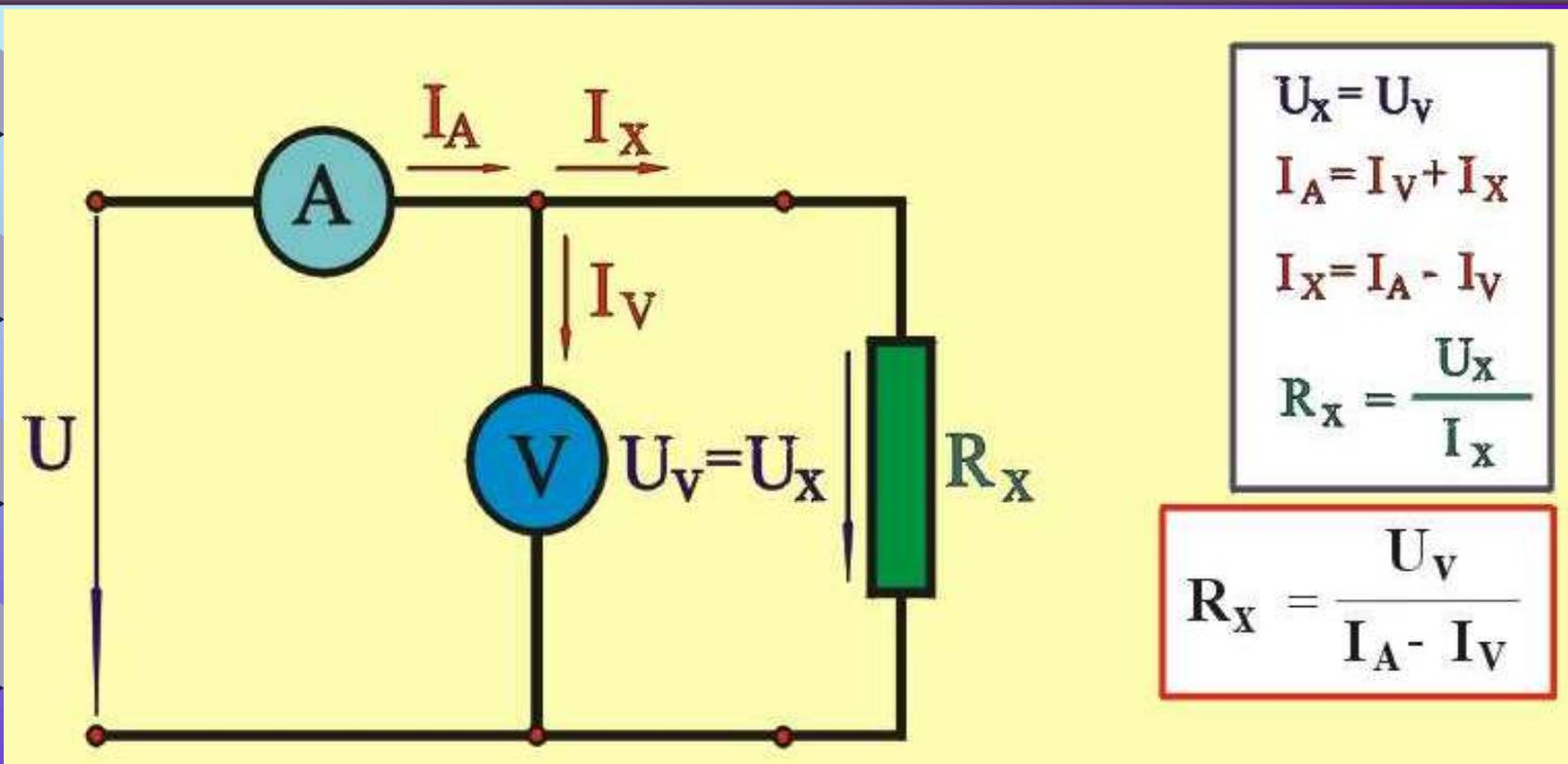
Vezava s tokovno napako (ampermeter pred voltmetrom) je primerna za merjenje majhnih upornosti.
